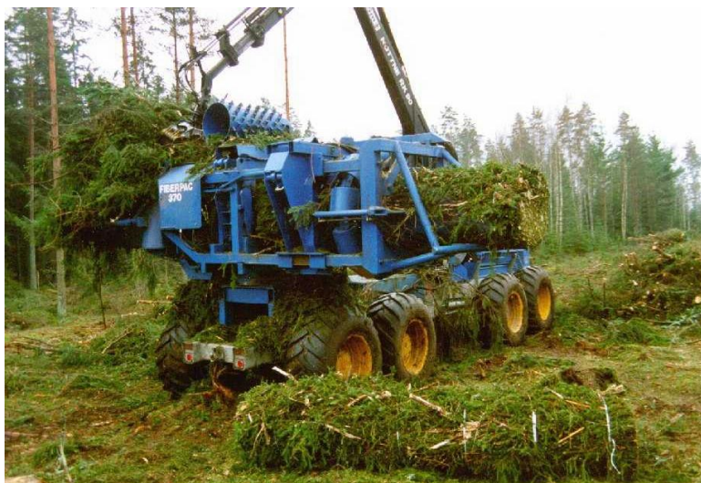
Figur 1. Fiberpac 370 monterad på en Rottne SMV 18-tons skotare.
