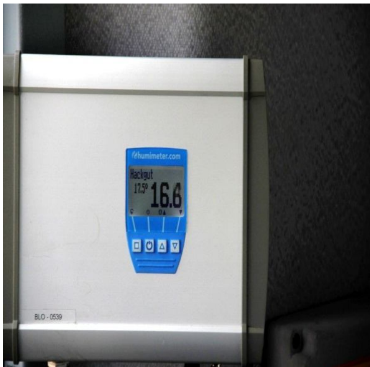
Figur 2. Fukthaltssensorns display visar löpande mätvärden under flisningen. I detta fall 16,6 % fukthalt. Medelvärdet av dessa sparades tyvärr inte någonstans i systemet.
