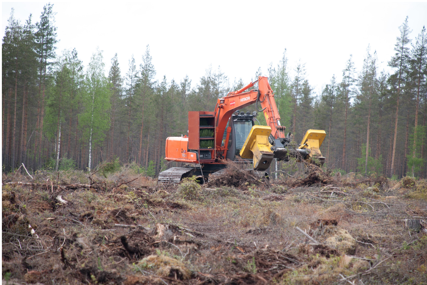
Maskinell markberedning eller, som på bilden, maskinell markberedning-plantering kan vara en "tjänstebreddning" som passar drivningsföretag. Foto: Erik Viklund/Skogforsk
